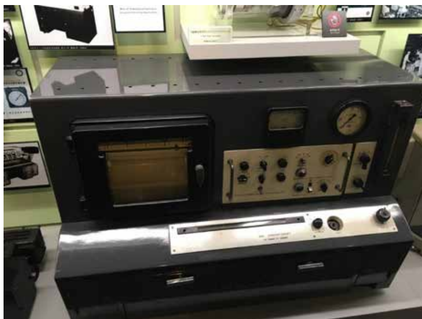
島津製作所が開発した日本初のガスクロマトグラフ
